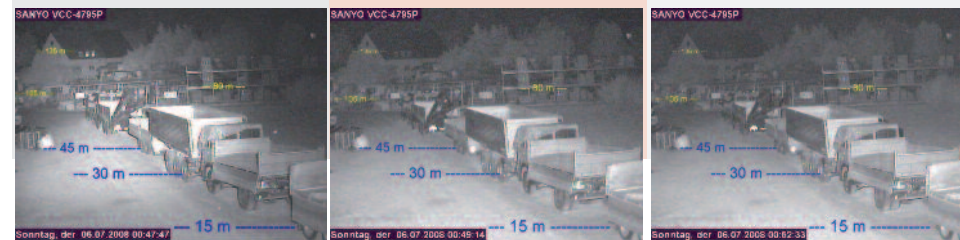
Kamera: SANYO VCC-4795P/4790P Objektiv: IR-korrigiert, geeignet für Tag-/Nachtbetrieb, 1:1,4 / f = 10 - 40 mm, Einge-stellte Brennweite (f) 10 mm
